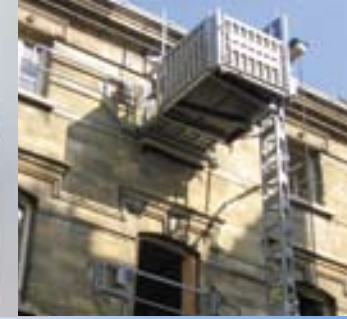
Monte-matériaux mono-mât - Charge utile 500 kg.
